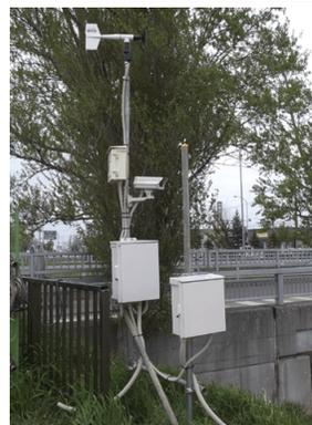
ウエザーターミナルサーバーWTS-01は、風向・風速・気温・湿度・水位・雨量などの気象データを測定するデータロガーKADEC-U21シリーズの通信コネクタに接続して、測定データをインターネット網に転送することが可能です。
