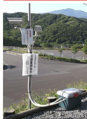
ウエザーターミナルサーバー機能付カメラは、ウエザーターミナルサーバーにカメラ機能を搭載したWebカメラです。解像度5メガピクセル（2592 x 1944）のCMOSイメージセンサを採用していますので、低消費電力ながらも高解像度なカメラです。撮影した画像をウエザーターミナルサーバー機能により、インターネット回線で伝送することや、あらかじめ設定した撮影間隔でUSBメモリに長期間記録することもできます。ただし、使用するUSBメモリサイズと電源容量および、設定する画像改造像度と撮影間隔によって最大記録時間が決まります。
