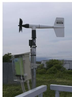
ウエザーターミナルサーバーWTS-RADは、風向風速計・気温計・湿度計・雨量計を直接入力できる機能を有したウエザーターミナルサーバーです。Webカメラ機能も標準機能です。また、警報設定条件（風速15m/sなど）をあらかじめ登録しておきますと、測定値が設定条件となったとき、携帯電話などのメール送信先に、警報メールとして配信することができます。ウエザーターミナルサーバーWTS-RADをデータロガーとして使用するときは、外部商用電源を接続することをお勧めします。
